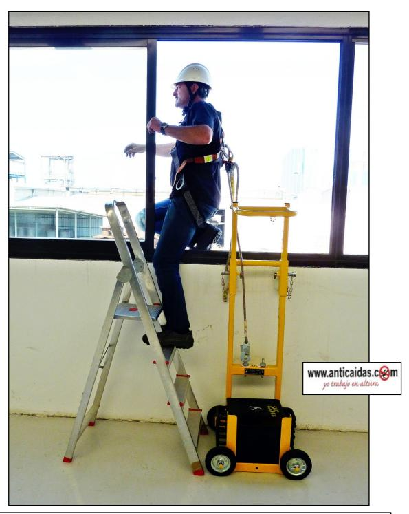
Ejemplo de aplicación correcta Se recomienda realizar un curso de sistemas anticaidas, para la utilización correcta del sistema. Debe de tener contemplado un sistema de evacuación o rescate.
