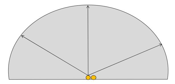
■ EJEMPLO DE TRABAJO EN RESTRICCIÓN EN CUBIERTA SEMICIRCULAR CON LINEA DE ANCLAJE ANTICAIDAS
